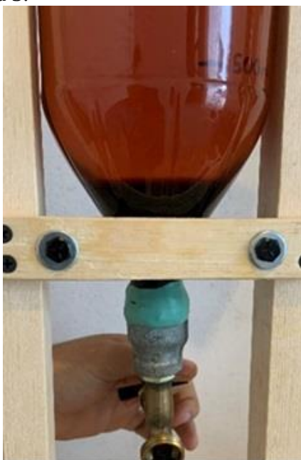
Figura 3. En el decantador prototipo se observa el biodiésel en la parte superior y glicerina en la inferior.
