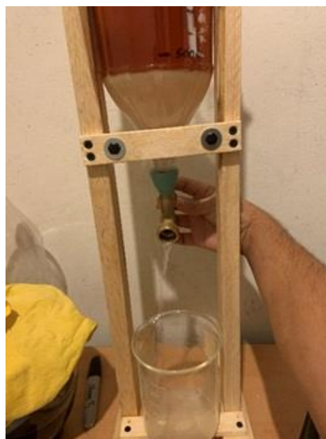
Figura 4. Separación del agua jabonosa del biodiésel lavado.
