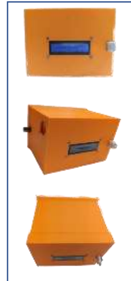
Figura 4. Nodo de sensado (CO 2 , TVOC, Temperatura, Humedad).
