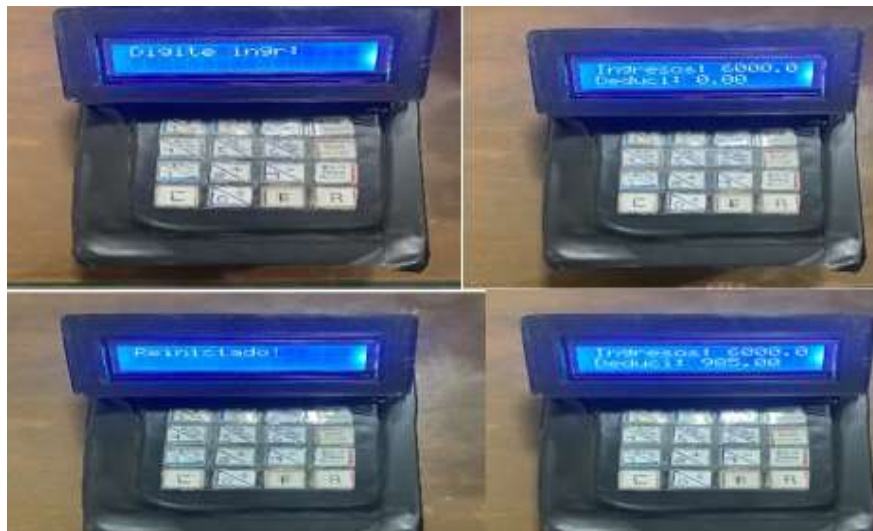
Figura 7. Interfaz del dispositivo para ingresar, reiniciar y acumular los datos.
