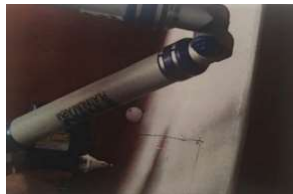
Figura 2. Brazo Faro con el cual se escaneo el álabe del rodete original.
