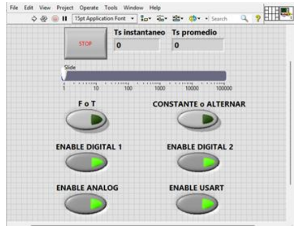
Figura 24. Instrumento virtual de prueba para medir T_{fn} y T_{fn\_promedio} .
