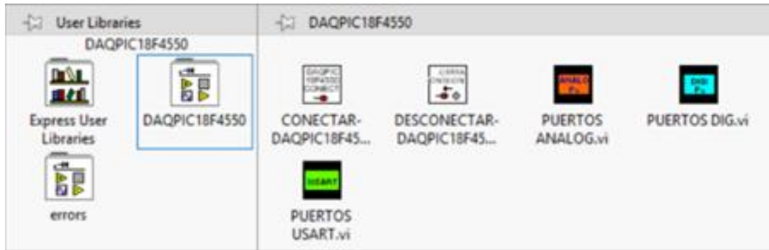
Figura 5. Librería integrable en LabVIEW para controlar la DAQPIC18F4550.
