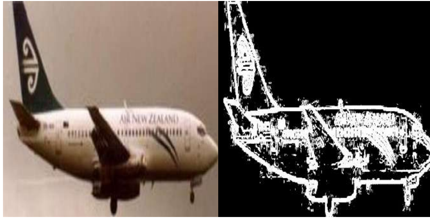
Figura 1. Detección de bordes mediante filtro de Sobel.
