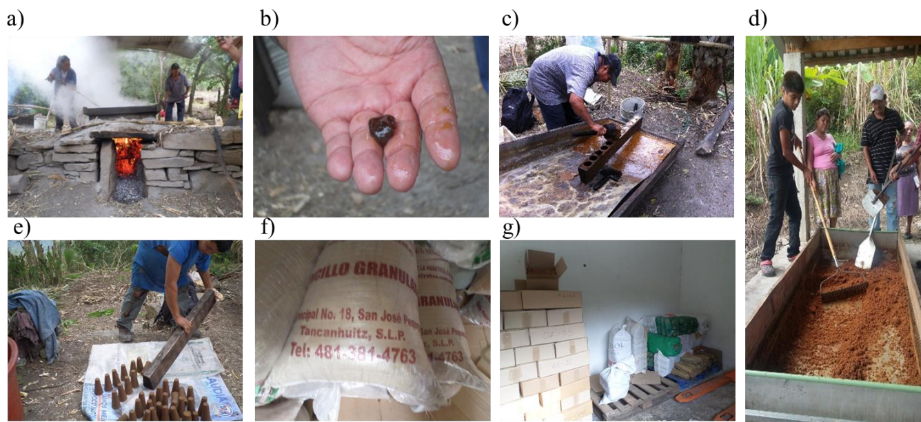
Figura 3. Evaporación y moldeado del piloncillo. Evaporación del jugo de caña(a). Detección del punto de cristalización (b). Vaciado de la meladura (c). Granulado y tamizado del piloncillo (d). Desmante de los moldes del piloncillo en cono (e). Almacenado del piloncillo en cono y granulado (f y g).
