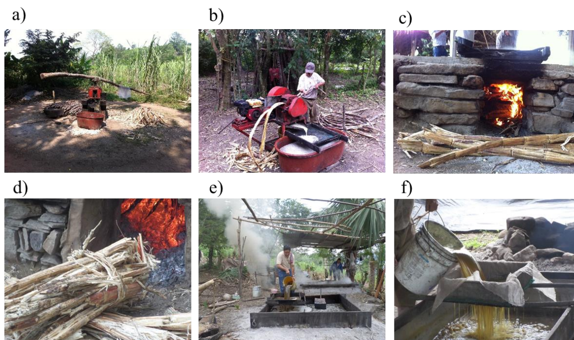
Figura 2. Proceso de obtención del jugo de caña. Extracción de jugo de caña de azúcar utilizando un trapiche de tracción animal (a) y motorizado con gasolina (b). Horno para puntera usado para la evaporación del agua del jugo de caña de azúcar (c). Bagazo de caña (combustible) (d). Filtrado y llenado de punteras (e y f).
