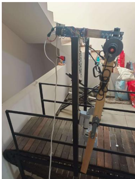
Figura 6. Ensamble del T.O.A., mostrando estructura que simula la pelvis y las extremidades inferiores.
