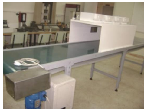
Figura 4. Equipo de radiación de microondas (Sahin, 2014).
