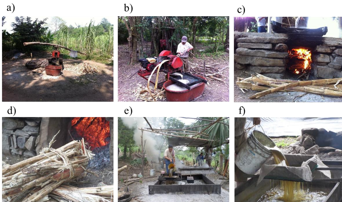
Figura. 2. Proceso de obtención del jugo de caña. Extracción de jugo de caña de azúcar utilizando un trapiche de tracción animal (a) y motorizado con gasolina (b). Horno para puntera usado para la evaporación del agua del jugo de caña de azúcar (c). Bagazo de caña (combustible) (d). Filtrado y llenado de punteras (e y f).
