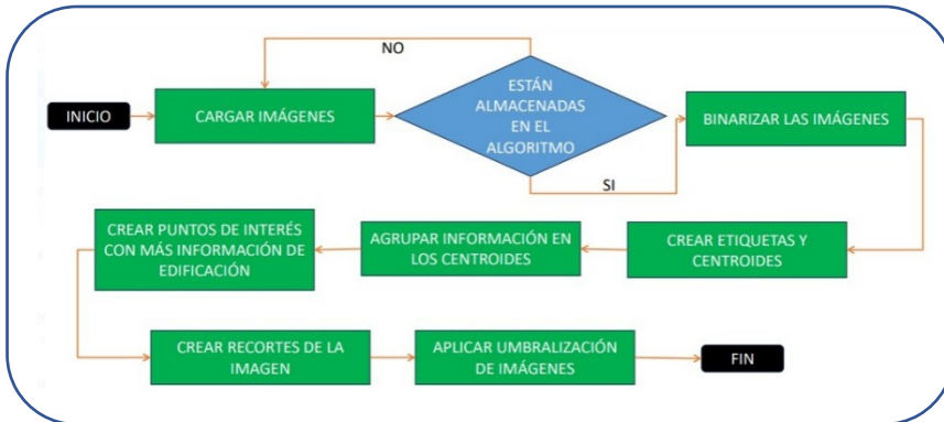
Figura 2. Diagrama de flujo del algoritmo de umbralización para el análisis del crecimiento urbano.
