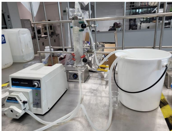
Figura 2. Sistema de adsorción de toxinas urémicas a nivel laboratorio del Departamento de Materiales Avanzados del Centro de Investigación en Química Aplicada (CIQA)
