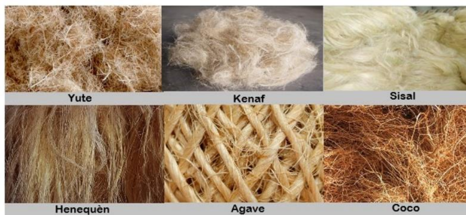
Figura 2. Diferentes tipos de fibras utilizadas como reforzamiento de plásticos.
