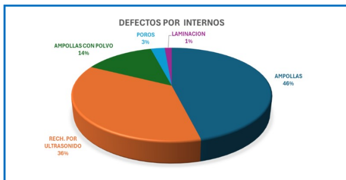
Figura 8. Defectos Interno de impacto en una acerera.
