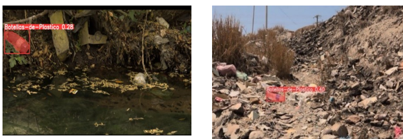
Figura 4. Segmentación de botellas, latas y cartón en el Parque Hundido de Saltillo, Coahuila, en escenarios con altos índices cromáticos.
