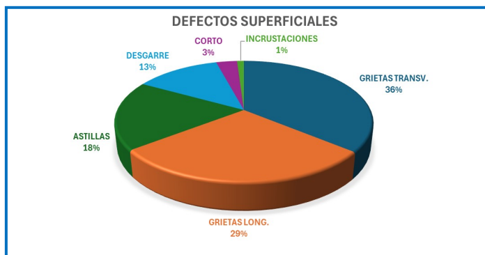
Figura 7. Defectos Superficiales de impacto en una acerera.
