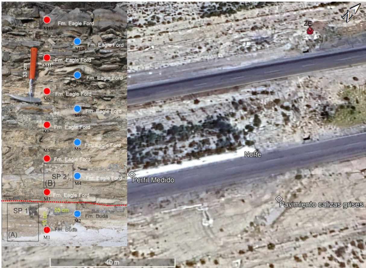
Figura 4. Puntos de medición de los valores espectrales de K %, eTh ppm y eU ppm, se realizó con un paso aproximado de 0.15 m en la vertical, alternando con 0.25 m en la horizontal en todo el corte. Las determinaciones paleontológicas se realizaron en secciones pulidas sobre dos muestras SP1 y SP2, a ambos lados de la línea de contacto (rojo discontinuo). La pica de geólogo sirve como escala.
