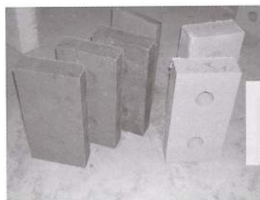
Foto 6 Prototipo de tabique sin cocción, con suelo del Ejido Palo Blanco, municipio de Castaños, estabilizado con cemento gris cal.
