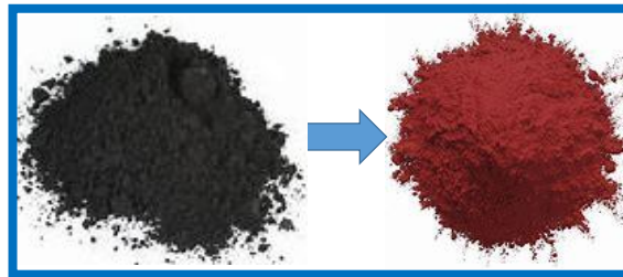
Figura 8. Termocromismo del óxido de cobre.
