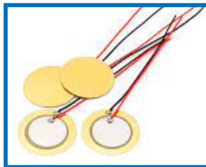
Figura 9. Sensores piezoeléctricos con óxido de cobre.
