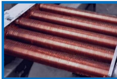
Figura 6. Aplicación del óxido de cobre como intercambiador de calor.
