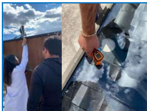
Figura 6. Medición de la temperatura del aire y de la pared del LoboSplit.
