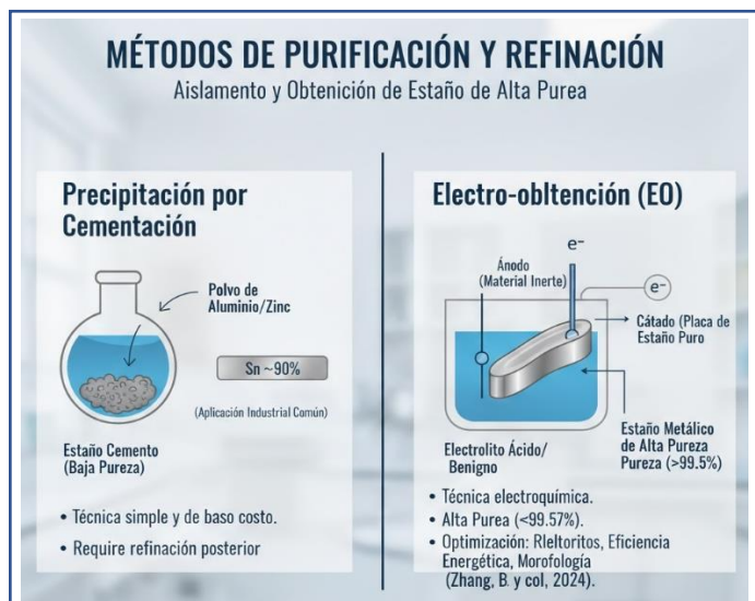
Figura 3. Métodos de Purificación y Refinación de Estaño: De la Solución al Metal Puro.
