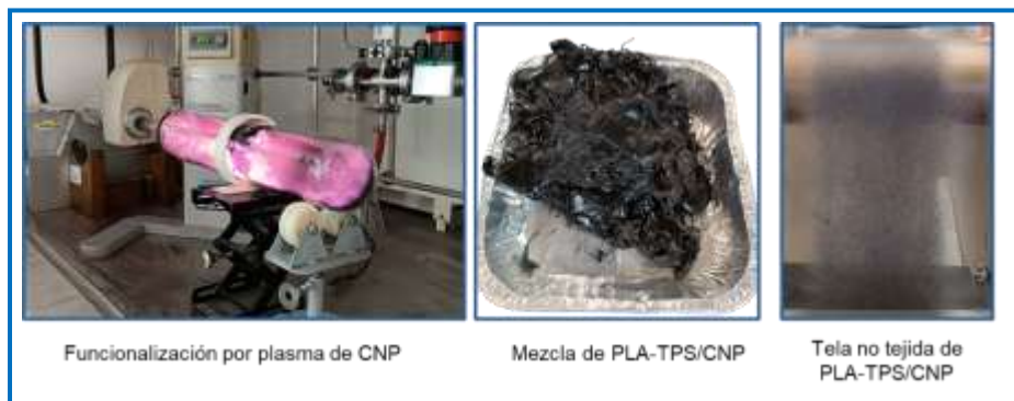
Figura 3. Proceso para la obtención de tela no tejida de mezclas de PLA-TPS/CNP mediante la funcionalización de la CNP, el mezclado en fundido y el procesamiento melt-blowing .
