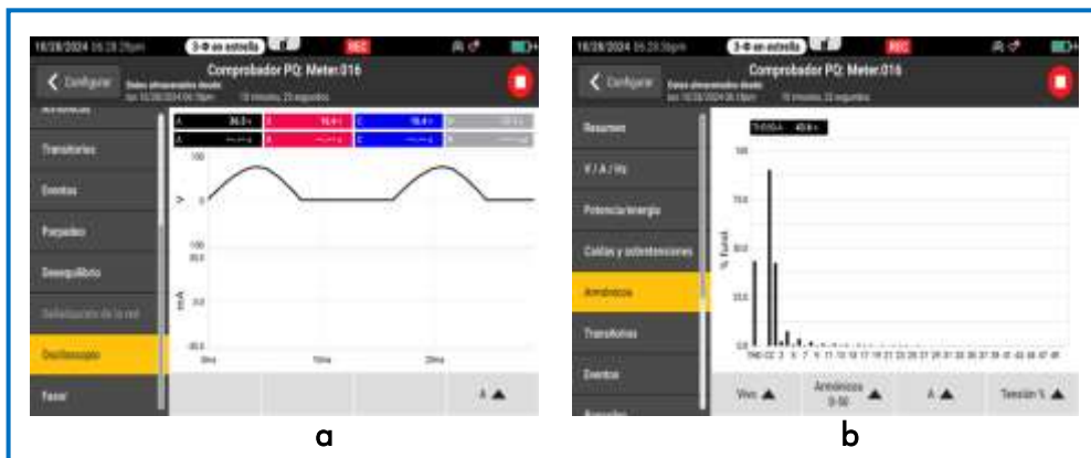
Figura 6. Resultados del analizador de energías, para rectificador de media onda (a) forma de onda de la señal y (b) contenido de armónicos.
