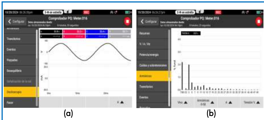
Figura 3. Resultados del analizador de energías, para onda sinusoidal (a) modo osciloscopio y (b) analizador de armónicos.
