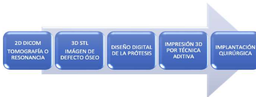
Figura 4. Flujo de trabajo de diseño 3D y manufactura aditiva para prótesis personalizada.
