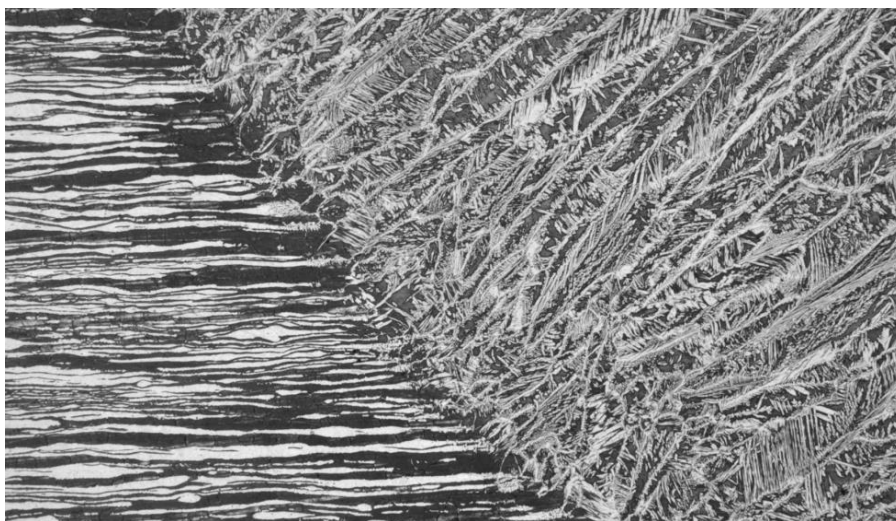
Figura 3. Microestructura de unión soldada de acero inoxidable dúplex.
