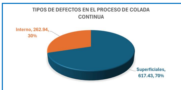
Figura 6. Defectos superficiales e internos en el proceso de colada continua.
