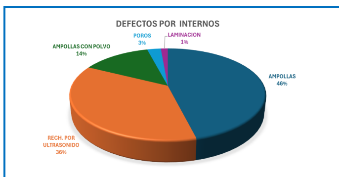
Figura 8. Defectos Interno de impacto en una acerera.
