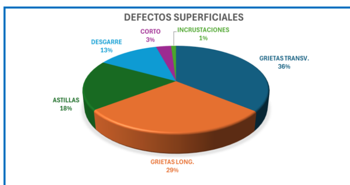
Figura 7. Defectos Superficiales de impacto en una acerera.
