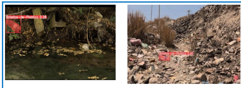
Figura 4. Segmentación de botellas, latas y cartón en el Parque Hundido de Saltillo, Coahuila, en escenarios con altos índices cromáticos.
