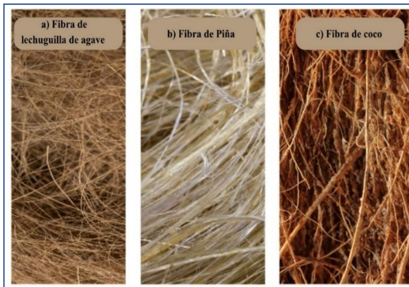
Figura 4. Caracterización visual de las fibras naturales: a) lechuguilla de agave, b) hoja de piña y c) cáscara de coco (CC).
