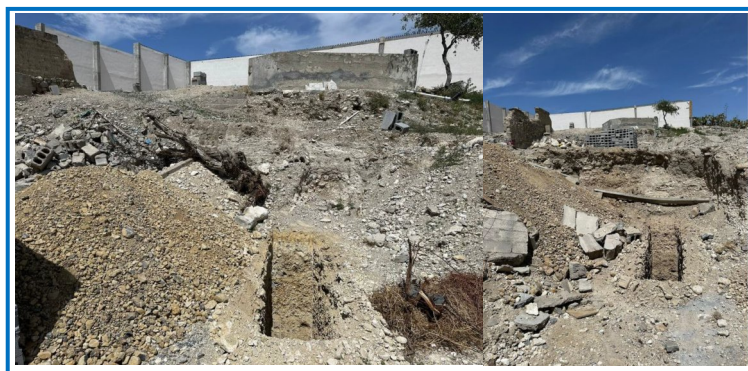
Figura 3. Sondeos realizados PCA-1 y PCA-2 en el cual se demuestra la estratigrafía homogénea.
